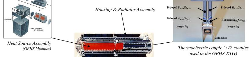
GPHS-Radioisotope Thermoelectric Generator (RTG)
